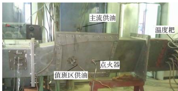
图2 冲压驻涡燃烧室试验模型
